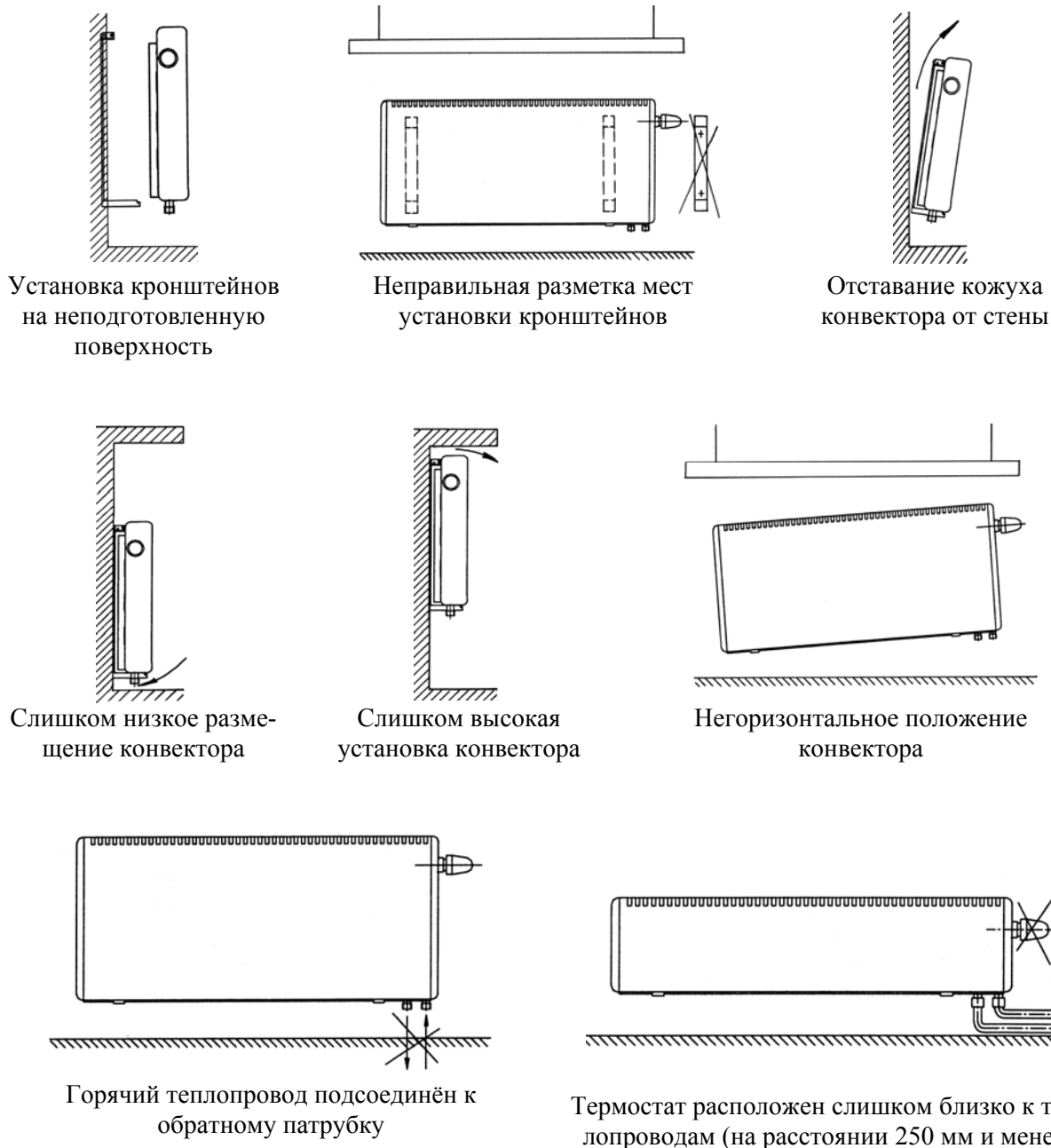
Рис. 6.2. Случаи неправильной установки конвекторов «Экотерм»
